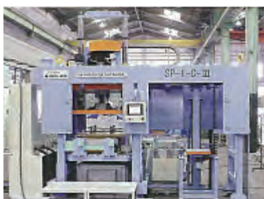
ダイレクトモータ式低圧鑄造機
